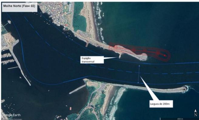
Imagem 14 – Entrada da barra do Rio Itajaí-Açu após o deslocamento do molhe norte (Navegantes)
